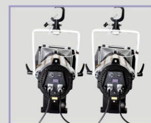
7. 高空多灯布光时,将U型架倒立固定于灯体,装好安全绳,保护灯体,用并联电源线来连接,可减少电源线的使用
